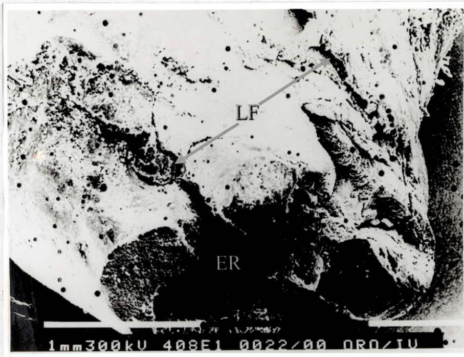
MUESTRA GRUPO VIII, MAGNIFICACION 4.08. OBSERVESE FRACTURA COHESIVA DIENTE.
