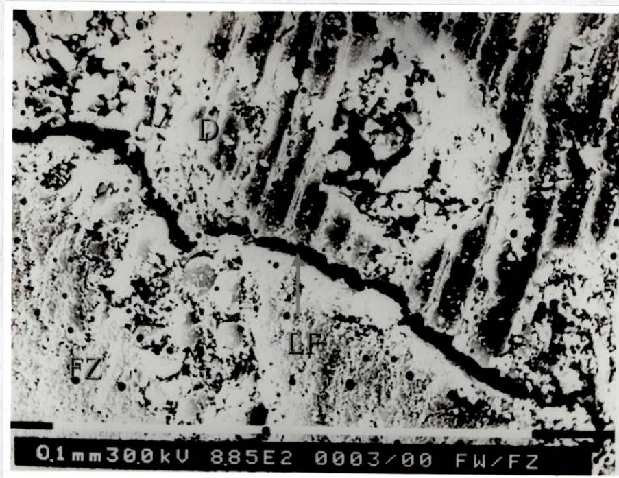
MUESTRA GRUPO III, MAGNIFICACION 8.85. OBSERVESE FRACTURA ADHESIVA CEMENTO-DIENTE.
