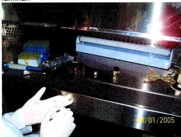
FOTO 3. CABINA DE FLUJO LAMINAR.
