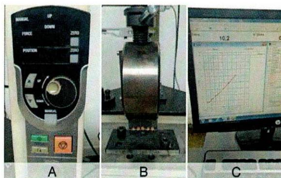
Figura 4. Máquina universal de prueba Instron. A) panel de control. B) Montaje en la máquina para pruebas. C) Lectura de resultados.
