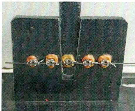
Figura 3. Fijación de brackets sobre las platinas de acero (arco Multiansas)
