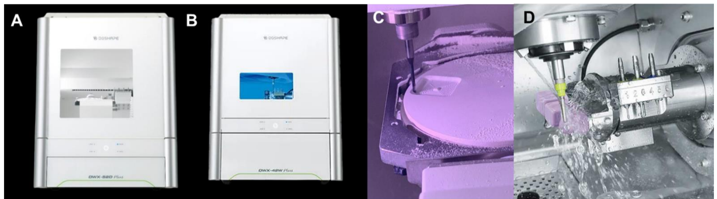
Figura 9. Proceso de fresado; A Fresadora DWX - 52D ®; B. DWX-42 W®; C. Fresado discos de Zirconio AT; D. Fresado bloques de Disilicato de Litio AT.
