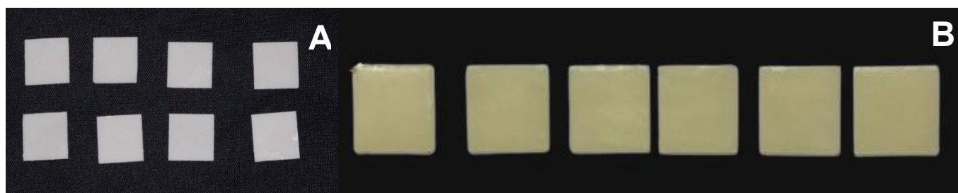
Figura 12. Láminas finales; A. Lámina de Zirconio AT finales; B Láminas Disilicato de Litio AT
