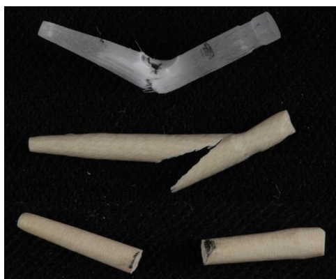
Figura 16. Fallas en los postes de vidrio fresados y de vidrio.
