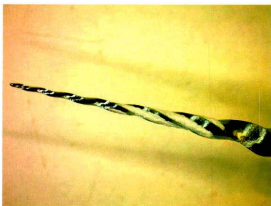
Fig. 3 Instrumento F2 con restos de resina en las estrías
