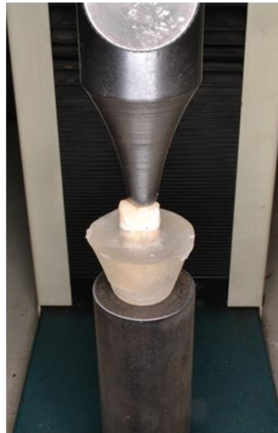
Figura 11. A) Colocación del espécimen en el indentador B) Especimen sometido a carga.
