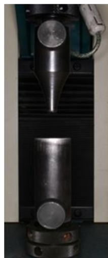
Figura 10. A. Maquina universal de ensayos TINIUS OLSEN B) Superficie de apoyo del espécimen e indentador.
