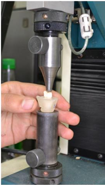
Figura 11. A) Colocación del espécimen en el indentador B) Especimen sometido a carga.
