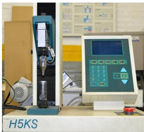
Figura 10. A. Maquina universal de ensayos TINIUS OLSEN B) Superficie de apoyo del espécimen e indentador.
