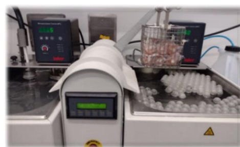
Fig.6 Proceso de termociclado SD Mechatronik
