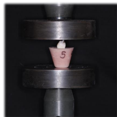
Fig.7 Máquina universal de ensayos Tinius Olsen modelo H50KS
