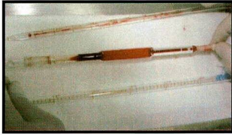
Figura 7. Muestra sangre + PBN en celda para líquidos
