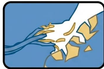
Falla de unión fibra-acrílico
