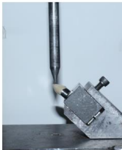
Imagen 7. Prueba INSTRON (3345) de las muestras, a 2mm debajo del borde incisal, cara palatina
