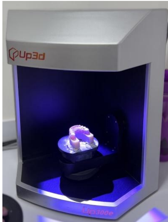
Figura 3: Escaneo de los enfilados maestros con escáner de mesa Up3d 300e.
