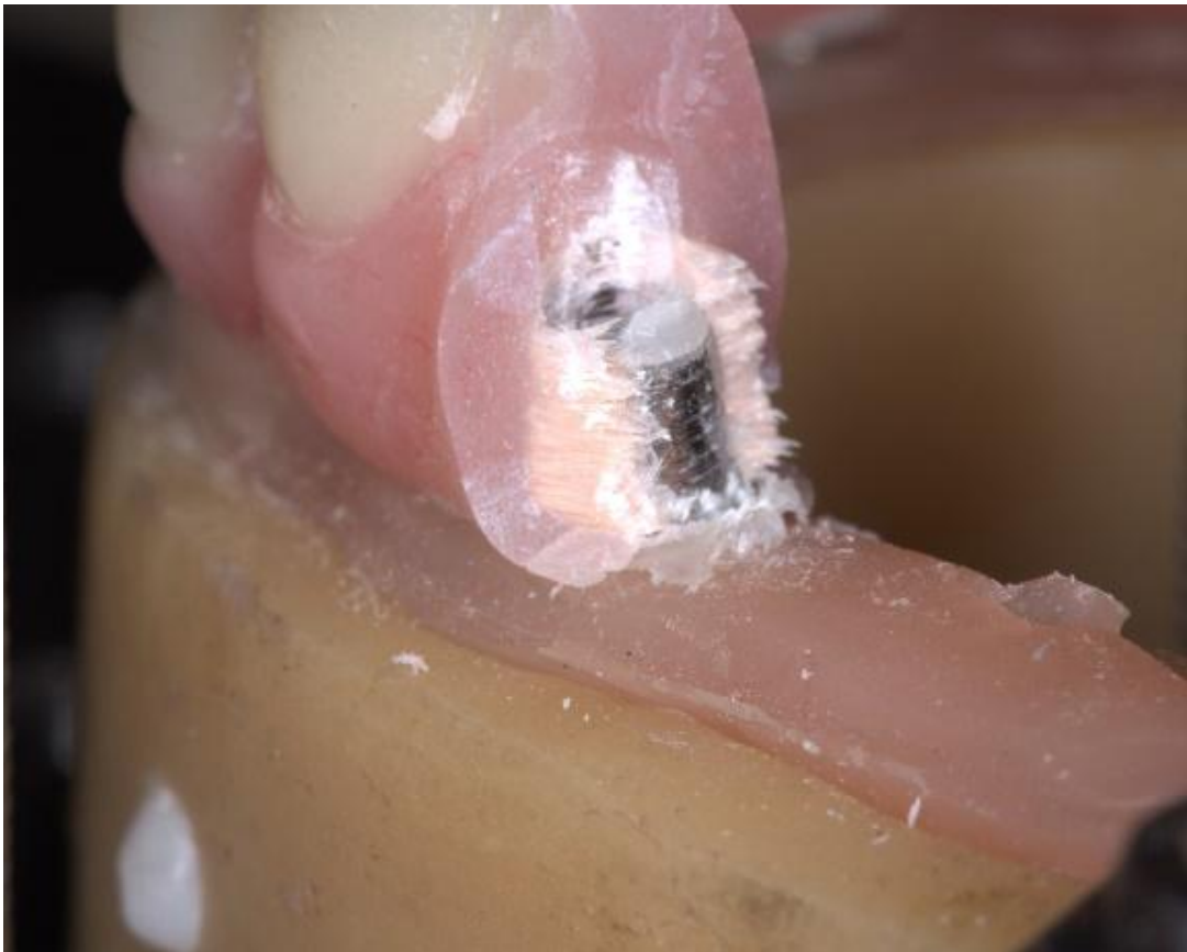
Figura 21: Proceso de prueba de esfuerzo realizada con maquina universal Instron, zona de voladizo izquierdo cuerpo de muestra 7 mm B.
