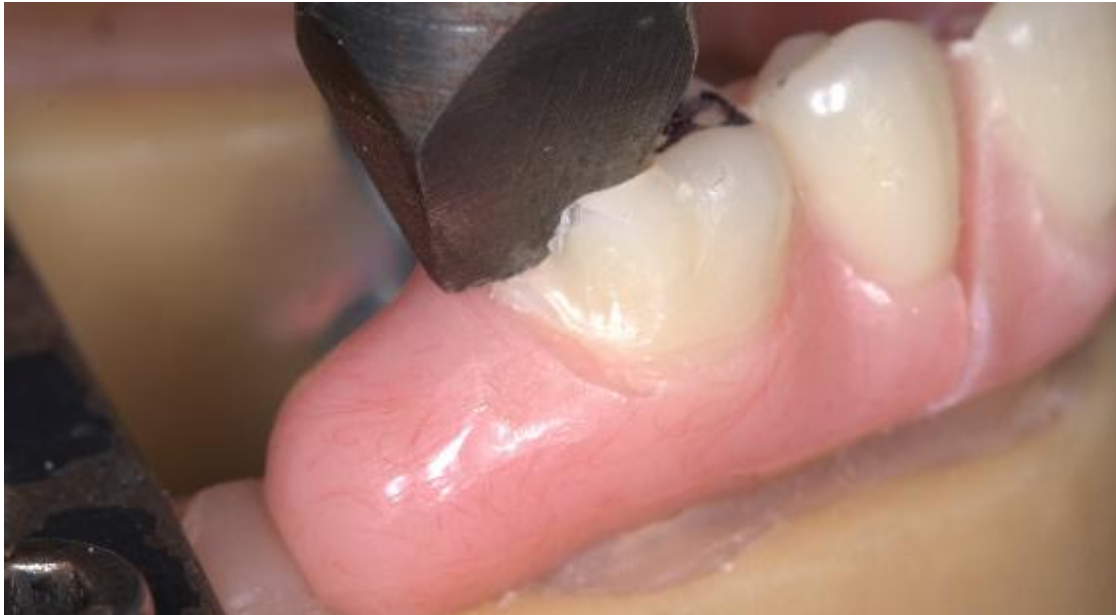
Figura 13: Proceso de prueba de esfuerzo realizada con maquina universal Instron, zona de voladizo derecho cuerpo de muestra 7 mm B.
