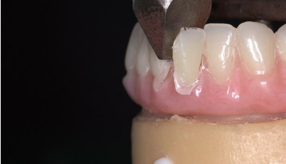
Figura 11: Proceso de prueba de esfuerzo realizada con maquina universal Instron, zona centro de cuerpo de muestra 10 mm A.
