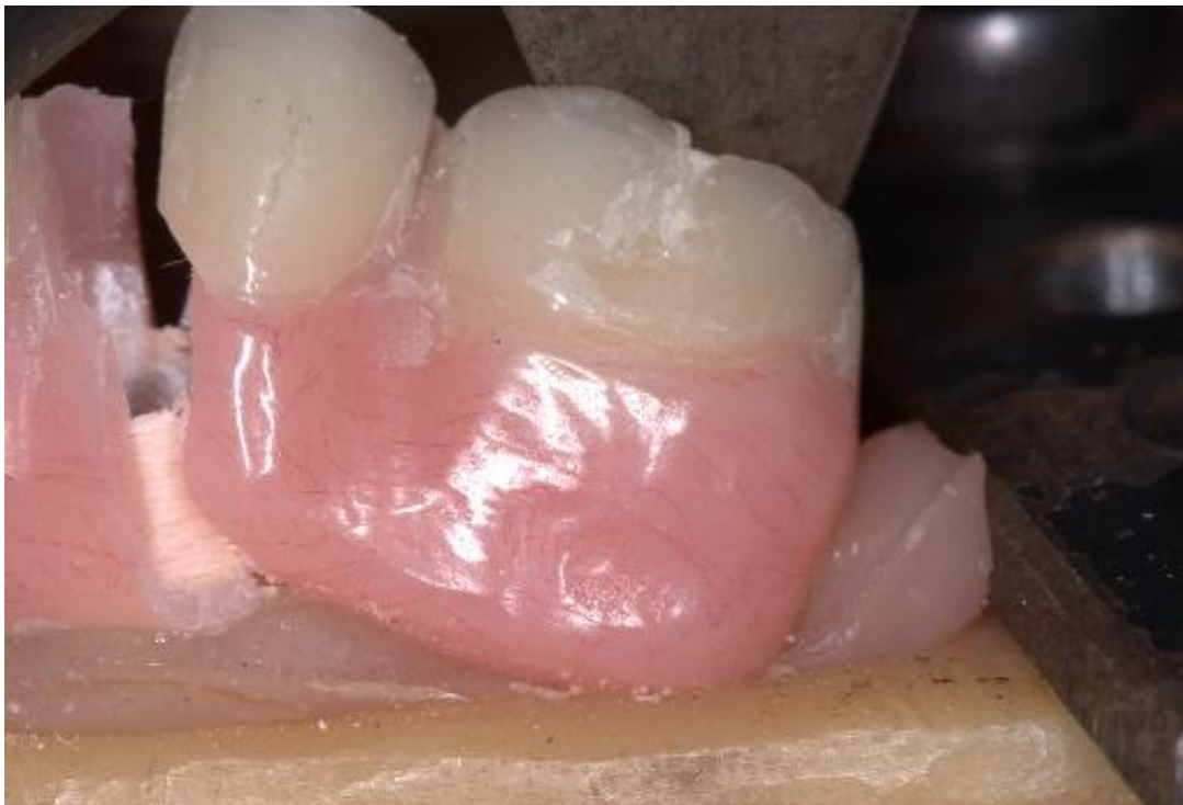
Figura 20: Proceso de prueba de esfuerzo realizada con maquina universal Instron, zona de voladizo izquierdo cuerpo de muestra 7 mm B.
