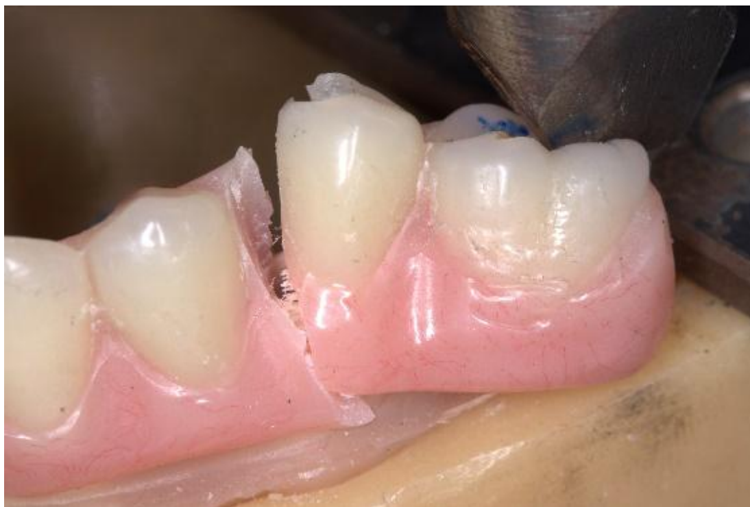
Figura 18: Proceso de prueba de esfuerzo realizada con maquina universal Instron, zona de voladizo izquierdo cuerpo de muestra 10 mm A.
