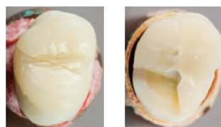
Figura 12. A) Especimen sometido a máxima carga B) Especimen fracturado
