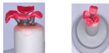
Figura 4. A) y B) Colocación de los encerados en el cilindro para revestimiento con su respectivo bebedero.
