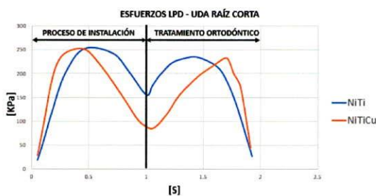
Figura 12 Comportamiento del esfuerzo en el LP durante el tratamiento de ortodoncia. La gráfica muestra en el eje (y) el valor de los esfuerzos y en el eje (x) pseudotiempo utilizado para el análisis (no es el tiempo que dura el tratamiento).
