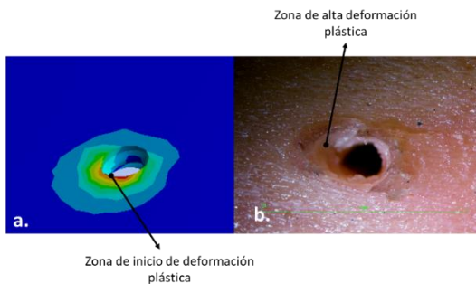
Figura 11. Comparación de los resultados de deformación obtenidos para el modelo computacional y experimental. a. modelo computacional: la franja roja indica la zona en donde se producirá la deformación plástica. b. modelo experimental: deformación plástica producida en el hueso cortical por el desplazamiento del mini-implante para una carga de 63,78N.
