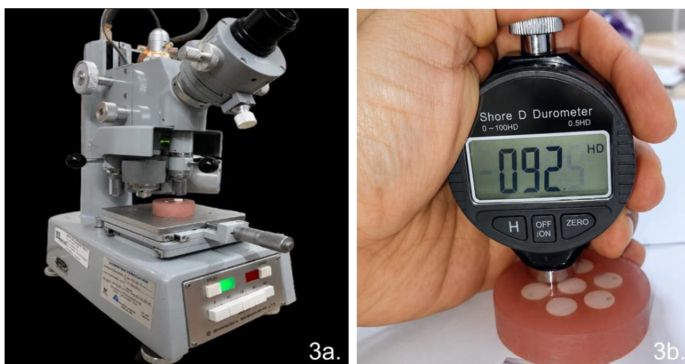
Figura 5. Evaluación dureza. 4a. Microdurómetro; 4b. Prueba Shore D.
