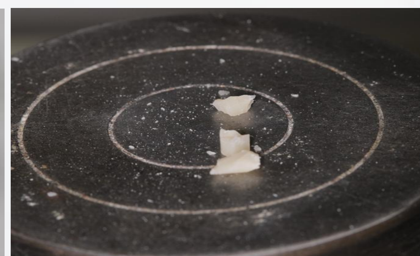
Cuerpo de muestra fracturado posterior a prueba de resistencia compresiva
