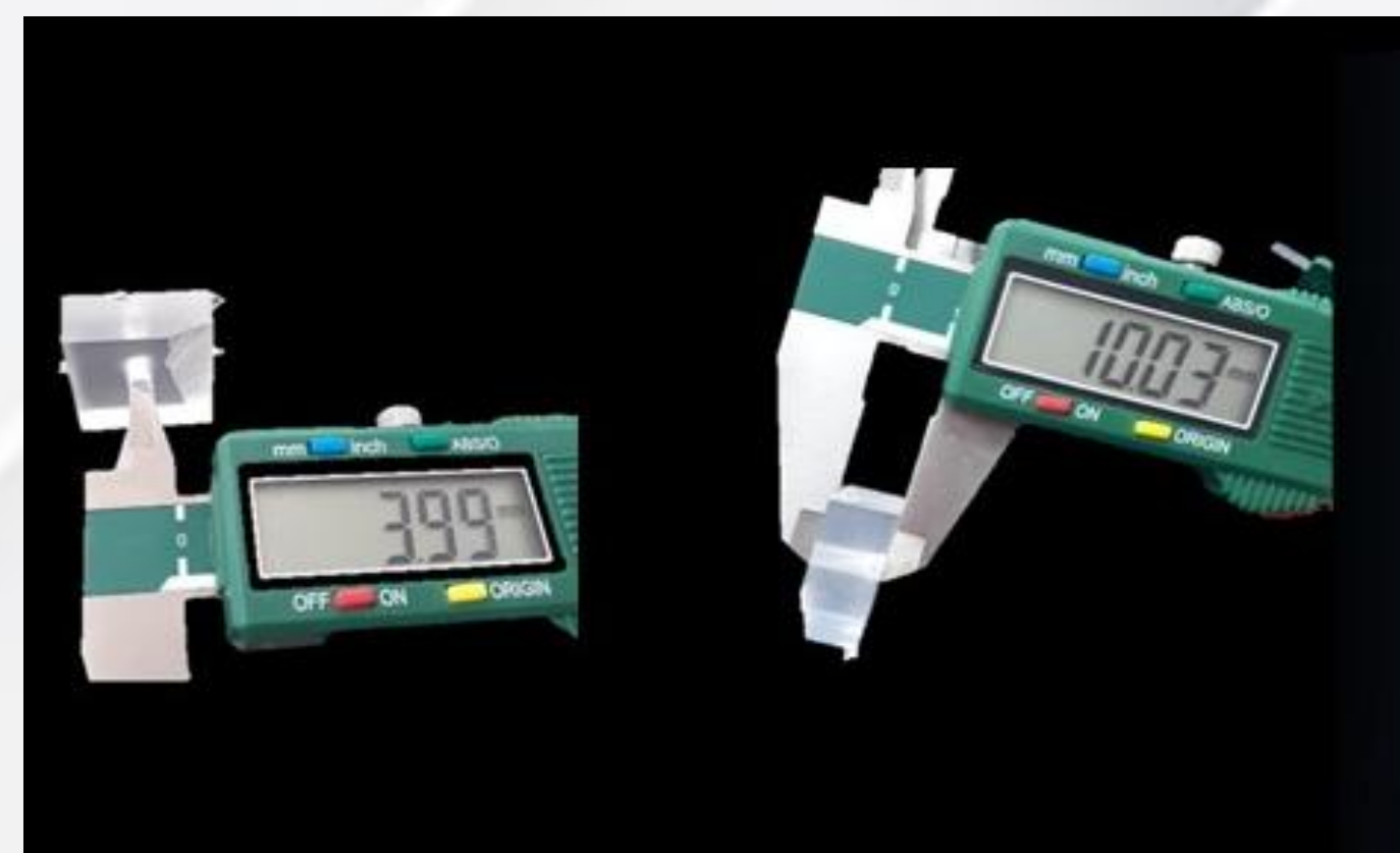
Calibración de moldes impresos para cuerpos de muestra con pie de rey
