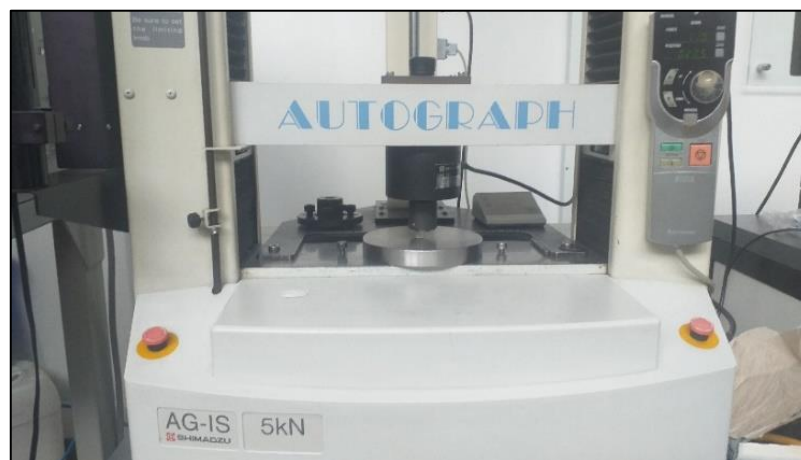
Ilustración 9. Ensayo mecánico de Resistencia compresiva
