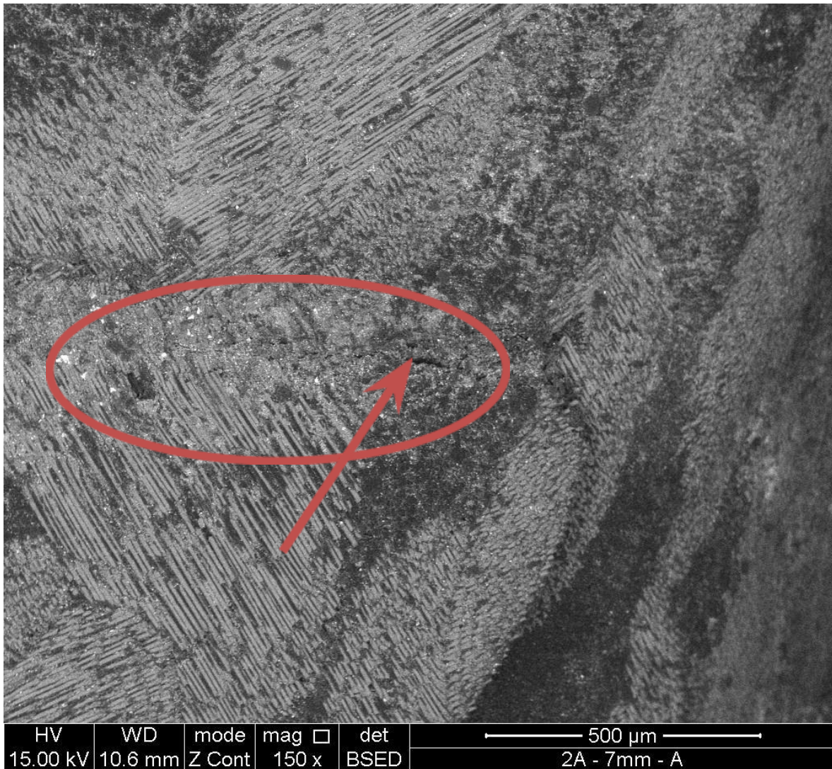
Ilustración 20. Falla cohesiva en el material.
