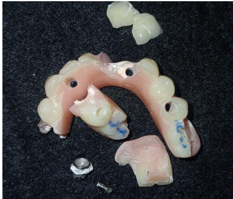
Ilustración 3 Fig 4. Estructura TriLor®, Voladizo 10mm A con revestimiento acrílico de termocurado fracturada.
