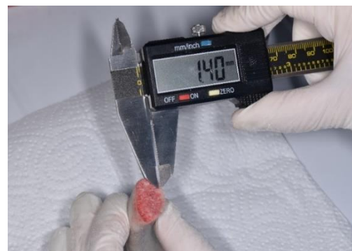
Figura 2. Grosor de hueso cortical de 1,4mm
