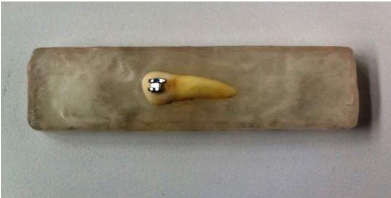
Figura 5 Bloque de acrílico usado con un premolar inmerso en la mitad, con bracket 3M™ cementado en el centro de la corona clínica
