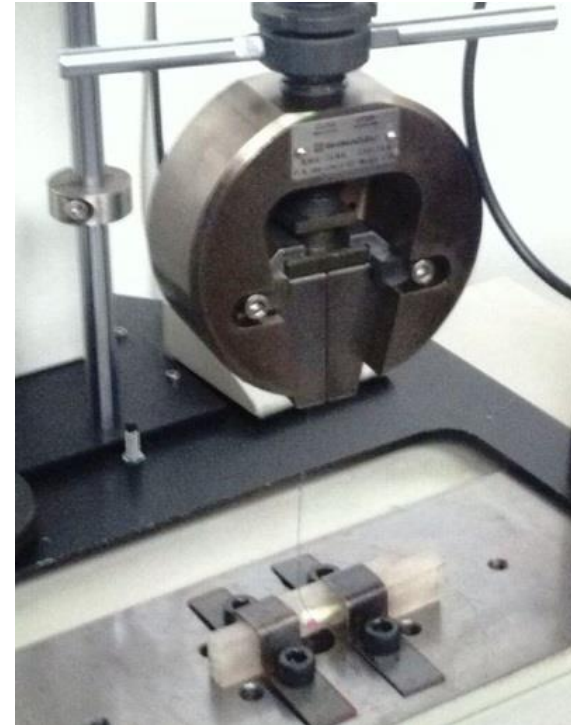
Figura 8. Dispositivo metálico tipo tenaza que sostiene el extremo libre de la ligadura metálica
