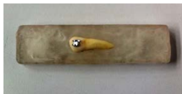
Figura 5. Bloque de acrílico usado con un premolar inmerso en la mitad, con bracket 3M™ cementado en el centro de la corona clínica
