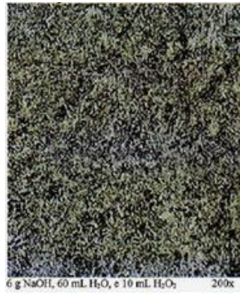
Figura 2. Metalografía minimplante titanio grado 5 ® (Ti6Al4V)
