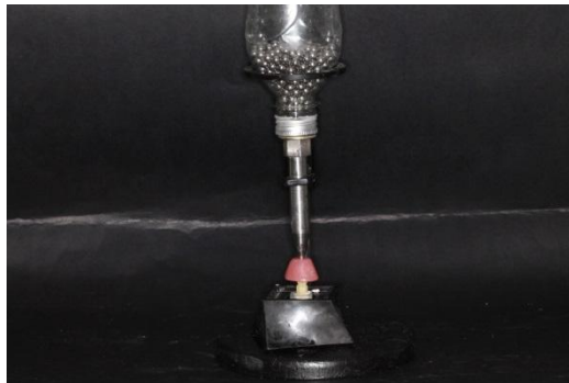
Figura 1. Cementación estandarizada con Dinamómetro a 400N de fuerza
