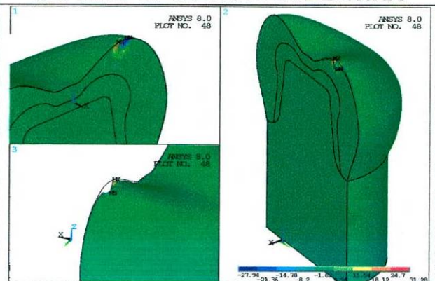
Figura 26. Esfuerzo principal máximo, valor máximo: 31.28 [MPa].
