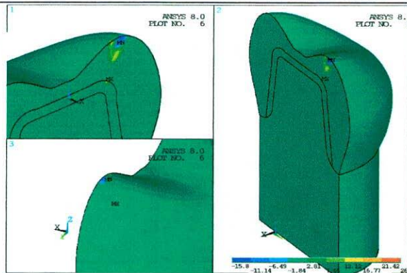
Figura 2. Esfuerzo principal máximo, valor máximo: 26.07 [MPa].
