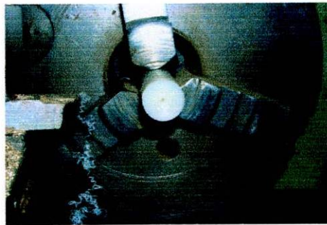
Fig.1 torneado industrial para elaboración de molde.
